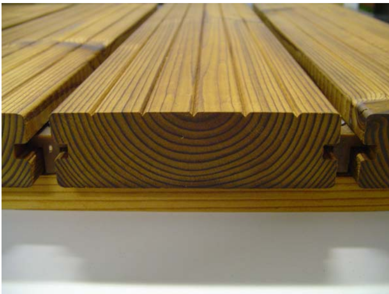
detaljbild av Lunadeck 2 ProFix trallprofil, observera att den smäråfflade s.k. kärnsidan av trallbrädan är avsedd som ovansida
